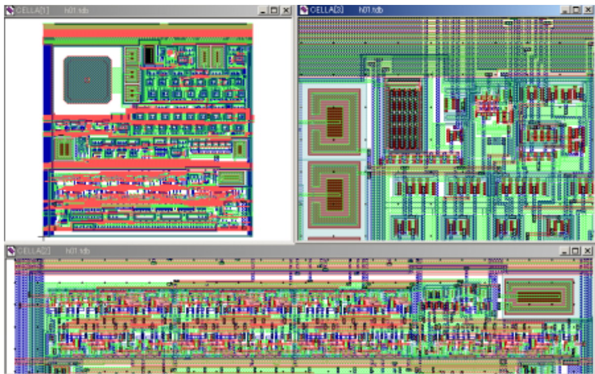
Figure 1: TANNER 社のレイアウトエディターを用いて、開発中のピクセル検出器のレイアウトデータを表示したものである。
